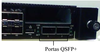
Figura 1. Painel frontal do Comutador PowerConnect 81xx
